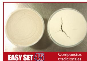
Grado de agrietamiento con espesores altos.
